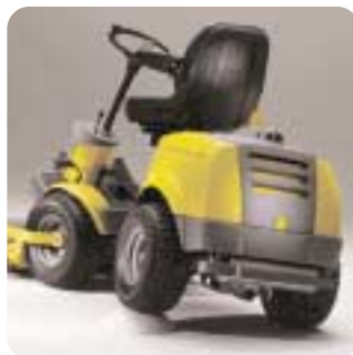
Umieszczone centralnie jarmzo radzi sobie nawet z nierówną powierzchnią.
