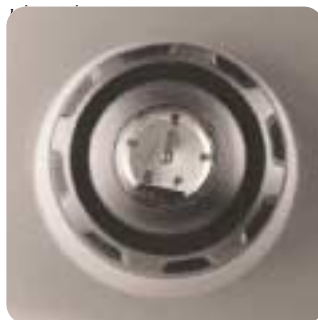
Wbudowany wskaźnik poziomu paliwa w korku wlewu.
