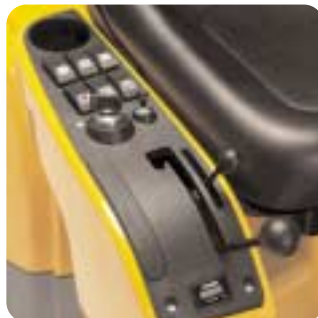
Stiga Park Pro Diesel jest równie prosta w obsłudze, jak inne kosiarki Stiga Park. Nie trzeba jej rozgrzewać. Wystarczy po prostu przekręcić kluczyk. Wspomaganie kierownicy, blokada różnicowa i automatyczna hydrostatyczna skrzynia biegów stanowią wyposażenie standardowe. Podnośnik hydrauliczny umożliwia podnoszenie zamontowanych akcesoriów do pozycji transportowej.
